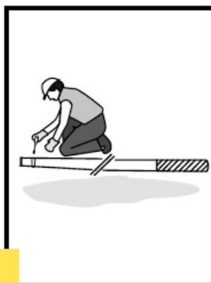
**2** Przygotowanie słupa - Uzbrojenie wierzchołka słupa w uchwyty kablowe do poprowadzenia przewodów między słupami
