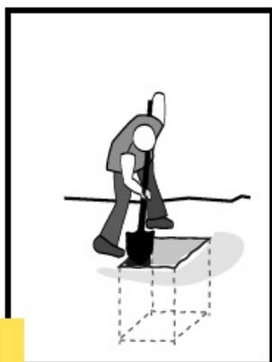
**1** Wykonać wykop na posadowienie części wkopywanej słupa zgodnie z wytycznymi,
