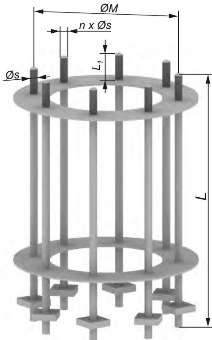
Fabriqué en acier de construction, il est composé d'ancrages à plaque qui répondent aux exigences standard pour les ancrages et d'anneaux de stabilisation qui positionnent les ancrages
